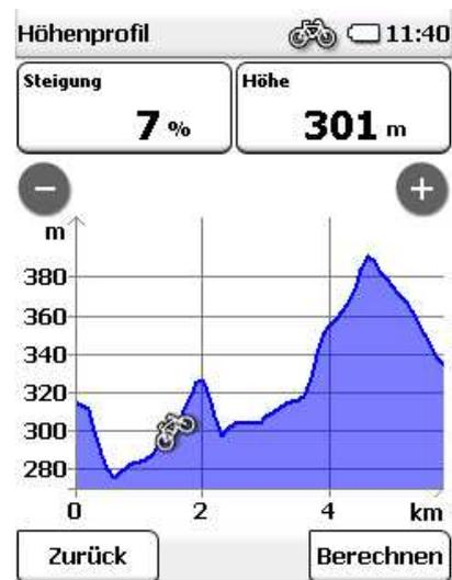
Wenn Sie einen Punkt auf dem Grafen anklicken wird dieser markiert und die Steigung und die Höhe zu diesem Punkt angezeigt. Durch Klicken auf eines der Infopfelder können verschiedene Werte ausgewählt werden, die dort angezeigt werden sollen.
